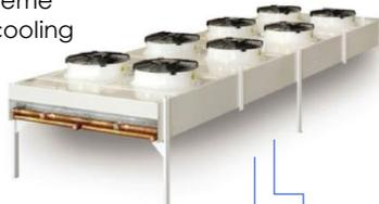
Le système de freecooling couvre 100% du besoin nominal en froid quand la température extérieure est au moins 3°C inférieure à la température de consigne
